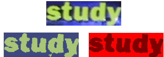
Figure 1 Image originale (au dessus), application de Fuzzy C-means (gauche) et k-means (droite) avec K=2.
